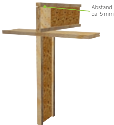
Stegverstärkung am Auflager
